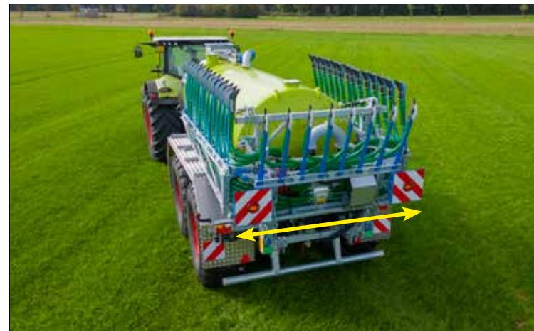
Sehr kompakte Transportstellung von nur 2,55 m
