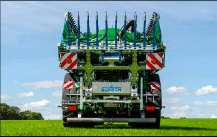
In Transportstellung stehen die Federn schräg nach innen
