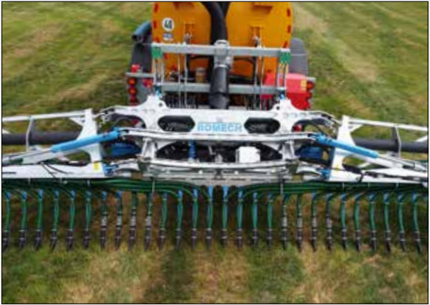
Reihenabstand 18,75 cm inkl. ASC-System für die Fahrgassen
