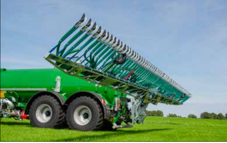
In Transportstellung stehen die Federn schräg nach innen
