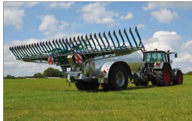
Sehr kompakte Transportstellung von nur 2,55 m
