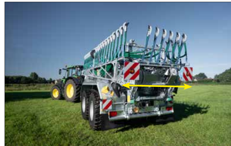
Sehr kompakte Transportstellung von nur 2,55 m
