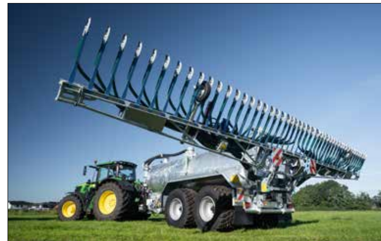
Sehr kompakte Transportstellung von nur 2,55 m
