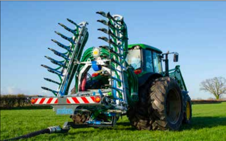
UP Ausführung in Transportstellung
