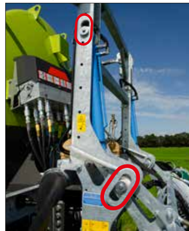
Hangausgleich im Mittelrahmen
